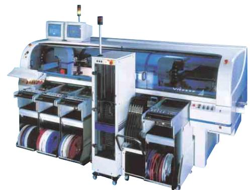
터 상당히 시간이 흘렀다. 칩 부품의 대량 장착 기술이 일본에서 실용화된 것은 1978년으로, 마쓰시타 전기산업이 박형 라디오에 3216 사이즈의 칩 부품을 중형의 플라스틱 카트리지에 채우고, 벌집 모양으로 나열한 카트리지에서 칩 부품을 일괄 픽업하고, 핀 프린트 전사한 접착제 상에 칩 부품을 일괄 탑재하여 접착제 경화 후 땀납조에 디핑하여 실장한 예가 처음이었다. 그 당시에는 테이핑 규격이 존재하지 않았기 때문에 벌크 공급이나 중형 카트리지로 공급하는 방법밖에 없었다. 그 후 8mm 테이핑 규격이 확립되어
