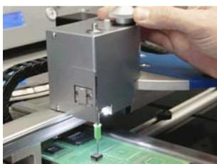
부품이 실장 위치 위로 옮겨지고 실장 위치에 가까이 오게 된다. 먼저 정확하게 회전하여 두 가지 방향으로 설정된다. 부품이 부드럽게 아래로 눌러지고 PCB 표면으로부터 0.5 ~ 1 mm 떨어진 위치에 멈춘다.
