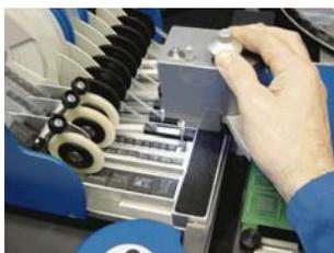
Feeders 의 Tape 슬롯이나 Stick Feeders 의 부품 캐리어, 또는 해당 팔레트로부터 선택 가능하다. 조작부를 PCB 의 해당 위치로 이동시켜 선택 방식에 따라 정밀하게 정의된 위치에 부품을 실장 한다.
